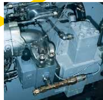
Capteurs de pression de type PPA avec une bonne tenue aux chocs et surcharges.
