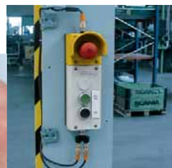
Boîte à boutons avec arrêt d'urgence dans l'industrie automobile.
