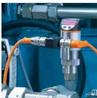
Capteur de pression ifm sur un groupe hydraulique.
