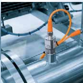
Le transmetteur de température TAA surveille la température du système.
