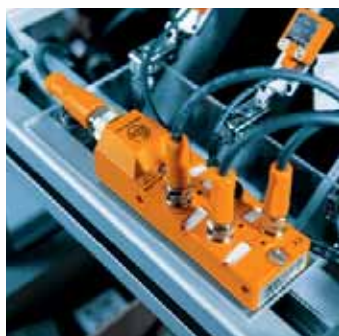
Module M8 AS-i étroit et plat avec la technologie ecolink éprouvée.
