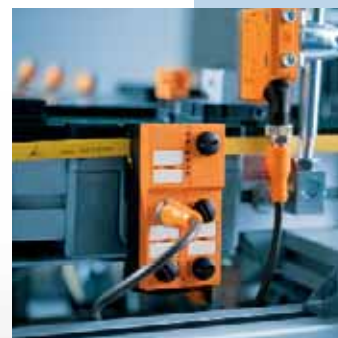
Montage sur rail DIN sans outils : utilisation décentralisée d'un module ClassicLine.
