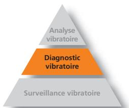
Les capteurs intelligents de vibrations facilitent la surveillance des niveaux de vitesse (mm/sec) et des niveaux d'accélération (g). Ce niveau de surveillance ne diagnostique normalement pas un défaut spécifique de la machine. Toutefois, en surveillant à la fois la vitesse et l'accélération, il est possible de détecter les augmentations de vibrations causées par une plus large série de problèmes, tels que :
