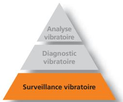
Les capteurs simples de protection de machines permettent une surveillance des niveaux généraux de vibrations, mesurés en vitesse (mm/sec). Ils sont couramment utilisés selon la norme ISO 10816. Ce niveau de surveillance ne diagnostique normalement pas un défaut spécifique de la machine. Toutefois, en surveillant à la fois la vitesse et l'accélération, il est possible de détecter les augmentations de vibrations causées par une plus large série de problèmes, tels que :
