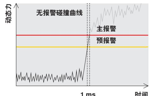
设备保护：主轴碰撞可在1 ms内检测
