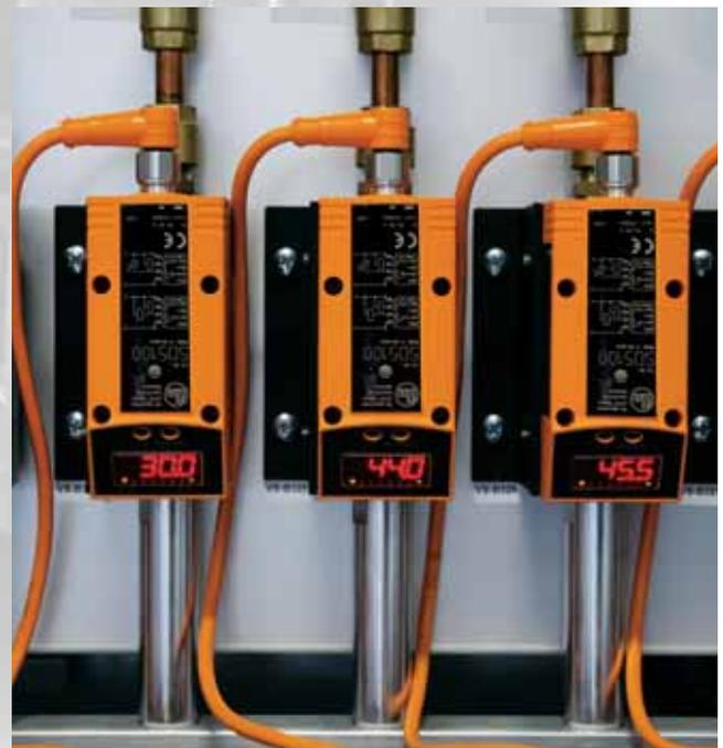
Mesure de la consommation d'argone dans un système de soudage laser.
