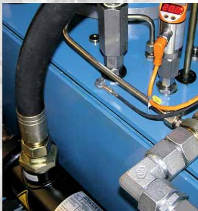
Sonde rigide avec boîtier électronique TR raccordé.
