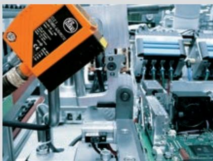
L'appareil compact est monté à l'aide du kit de montage correspondant et raccordé au système de commande via l'interface process. Le paramétrage est effectué via un câble Ethernet avec un PC standard.
