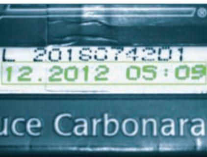
Le capteur de vision contrôle la présence d'étiquettes adhésives ou d'impressions, par ex. de dates de production ou de péremption. Le capteur détecte fiablement des marquages de couleur, comme points de montage ou marquages d'erreur - appliqués de manière mécanique ou manuelle.
