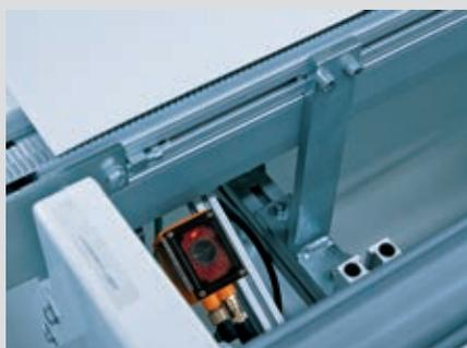
Contrôle de la production pendant la fabrication de modules solaires de Conergy AG : la décision a été prise en faveur du lecteur multicode en raison de son taux de lecture élevé. Les dimensions compactes et l'éclairage intégré permettent l'installation dans un espace réduit.
