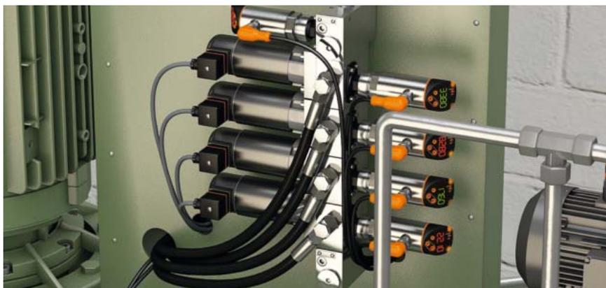
Pour surveiller la pression du système hydraulique, des capteurs de pression ifm de type PN sont utilisés. Des signaux process, des événements et des paramètres sont transmis au maître via IO-Link en numérique. Jusqu'à 8 capteurs IO-Link peuvent être raccordés au maître AS-i qui transmet les données au système de commande par PROFINET, EtherCat, EtherNet/IP ou Profibus.
