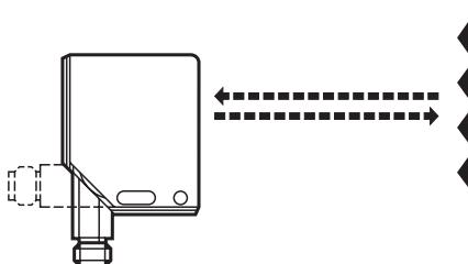
Fixer le réflecteur ou la bande adhésive réflex. Orienter la cellule réflex et la fixer avec une équerre de fixation.
