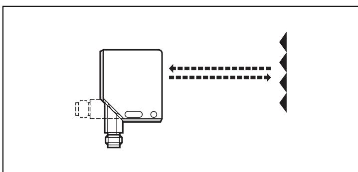
Befestigen Sie Tripelspiegel oder Reflexfolien. Richten Sie die Reflexlichtschranke darauf aus und befestigen Sie sie mit Hilfe einer Montagehalterung.
