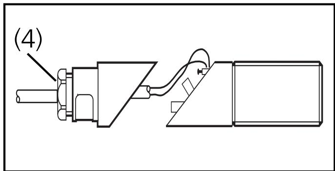
Sie können das Schrägstück gerade oder abgewinkelt montieren. Stecken Sie das Schrägstück entsprechend auf den Sensor und befestigen Sie es wieder mit der Schraube.
