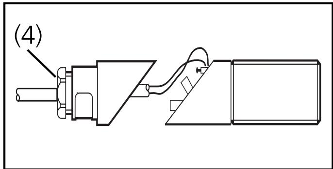
Le montage du capot peut être en droit ou coudé. Remettre le capot en position désirée sur le détecteur et le visser.
